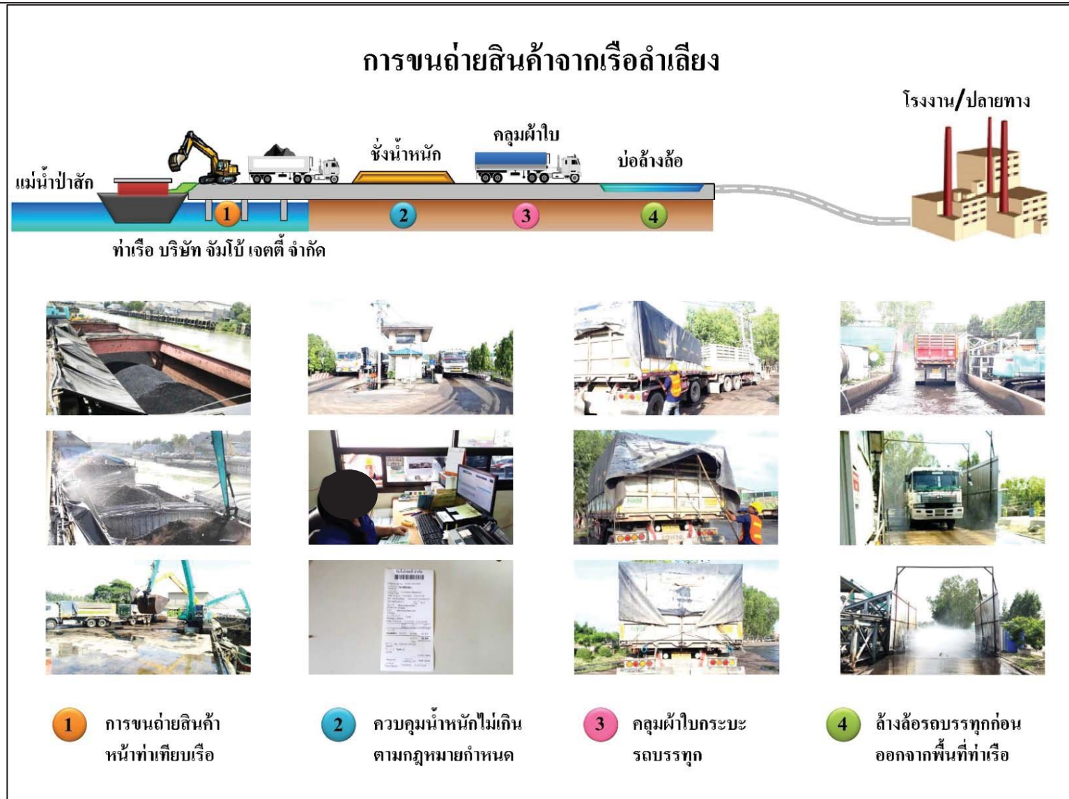
รูปที่ 1-6 วิธีการขนถ่ายสินค้าประเภทถ่านหินจากท่าเทียบเรือโครงการ
